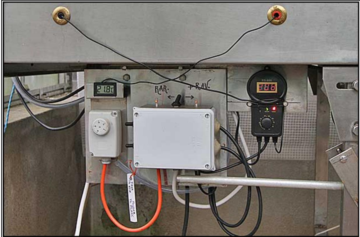
A droite, sous la table, l'intervallomètre pour l'humidificateur.
