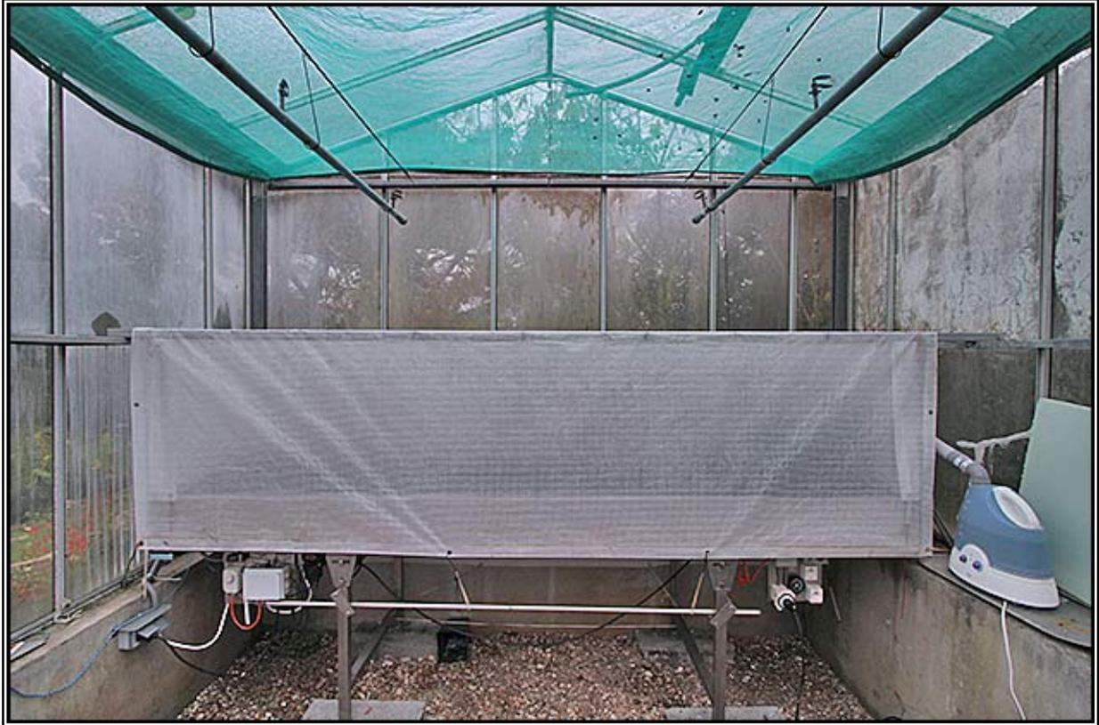
Bâche relevée. A droite, sur le muret, l'humidificateur qui envoie sa vapeur froide dans le tube plastique gris incliné vers le haut. Sous la table les différents contrôles.
